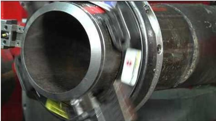
Oltre al modello standard NB ampiamente illustrato nella pagina precedente, ovvero la serie leggera, costruita completamente in alluminio, i modelli HD in acciaio, per lavorazioni speciali, tubi di altissimo spessore, materiali duri e tenaci e per grandi diametri. Questa gamma copre fino a 86" diam esterno
